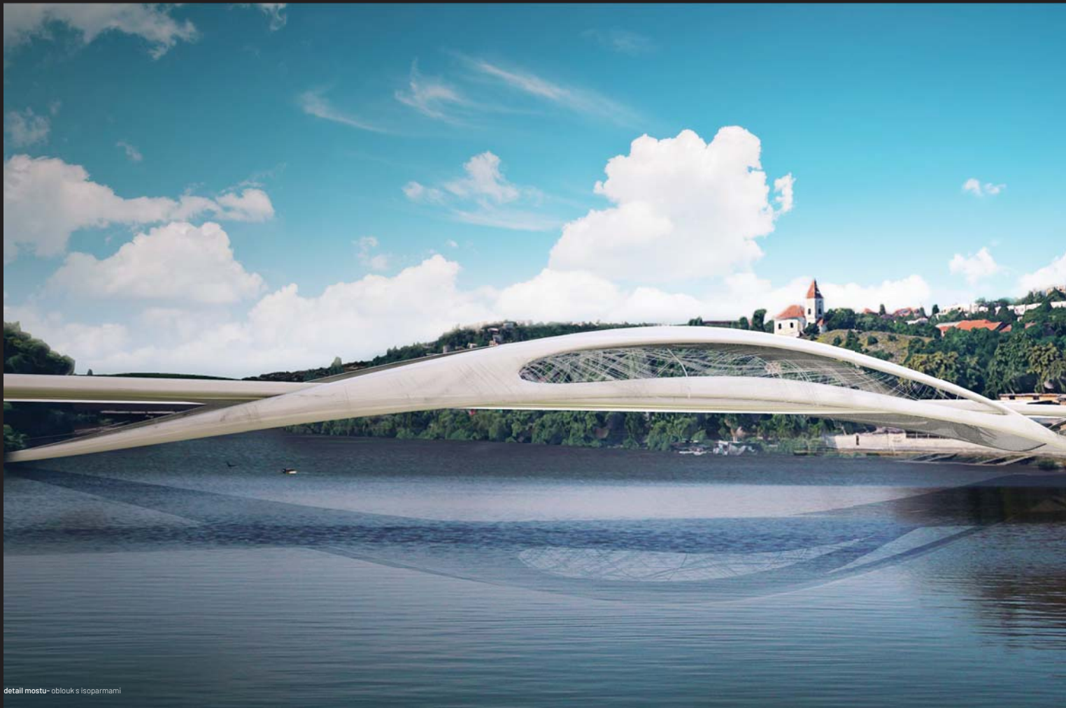
vývoj konceptu - evoluce návrhu vychází z přirozeného tvaru řetězovky.
