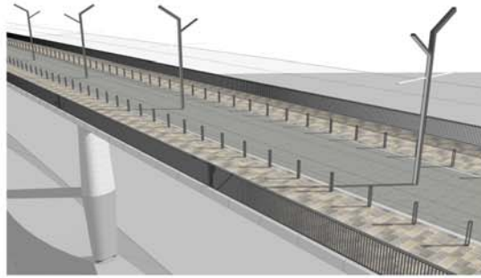
náhled zobrazující prostorové uspořádání ploch na mostě v jedné výškové úrovni, patrné je střídaní tvarů stožárů na mostě, desková kamenná dlažba ploch pro chodce a cyklisty, zarovnaná kamenná dlažba tramvajového pásu
